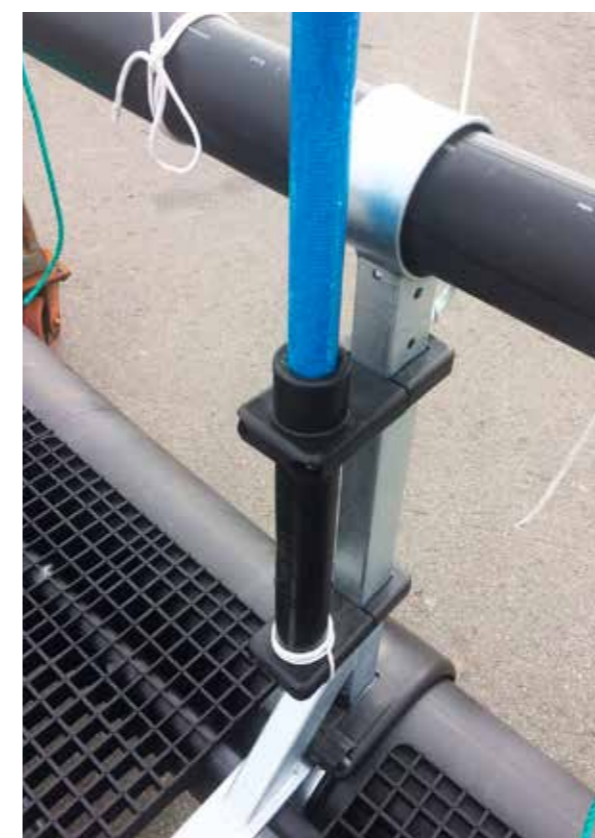
Innvendig tauføring i stenger.
